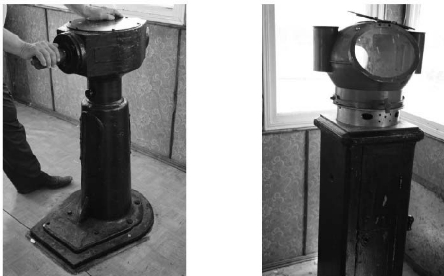
ПРИЛОЖЕНИЕ 2. ФОТОФИКСАЦИЯ. Фото 21,22. Средняя палуба. Рулевая рубка. Станина штурвала и стойка главного компаса - подлинные. Фото автора 2013г
