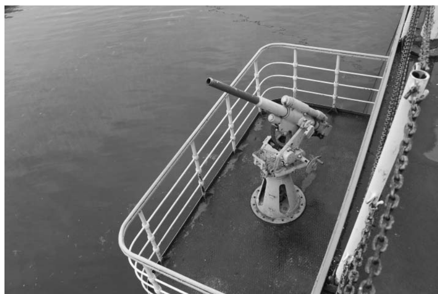
Фото А.А. Жильцов, август 2018 г. Вид на наращенную оружейную площадку с орудием по правому борту.
