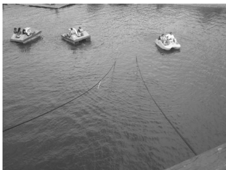
ПРИЛОЖЕНИЕ 2. ФОТОФИКСАЦИЯ. Фото 5. Вид на швартовы правого борта судна. Тросы частично затоплены. Фото автора 2013г.
