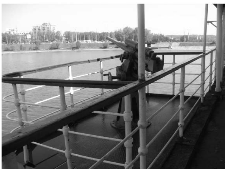
ПРИЛОЖЕНИЕ 2. ФОТОФИКСАЦИЯ. Фото 15. Орудийные площадки наращены по правому и левому бортам судна; орудийный расчет (законсервирован). Фото автора 2013г
