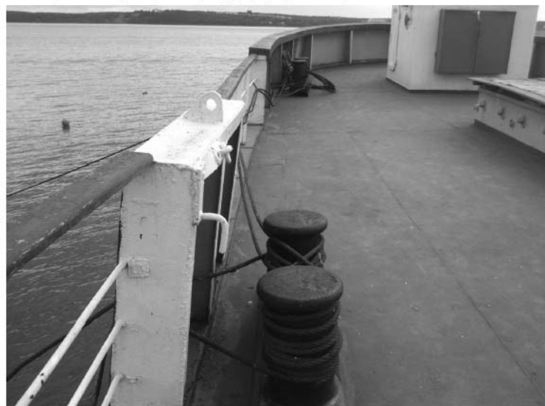
ПРИЛОЖЕНИЕ 2. ФОТОФИКСАЦИЯ. Фото 6. Крепление швартовочных тросов на палубе с правого борта судна ( корма). Фото автора 2013г.
