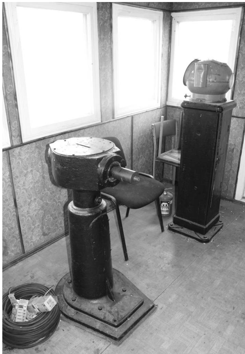
Фото А.А. Жильцов, август 2018 г. Рулевая рубка, вид на станину и стойку главного компаса.
