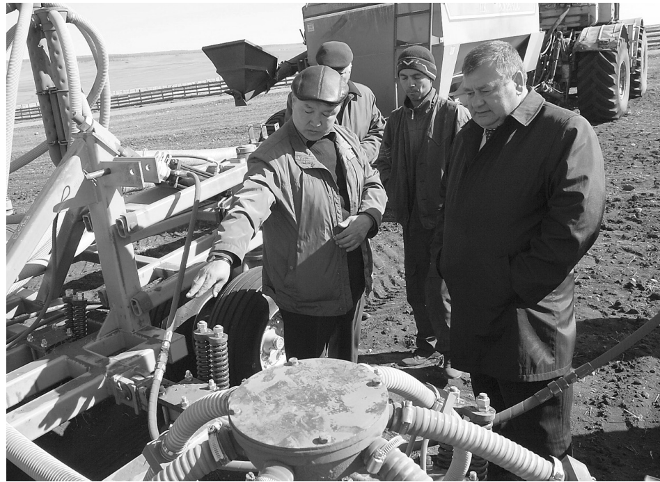
Новый посевной комплекс одновременно осуществляет пять операций: культивация, посев, внесение удобрений, боронование и прикатывание
